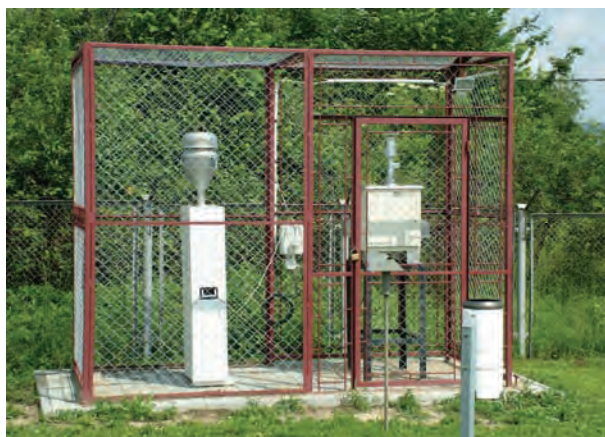
Ryc. 14.6. Sprzęt pomiarowy na stacji monitoringu przy ul. Floriańskiej w Jaśle – pobornik pyłu PM10, 2007 r. [44]
