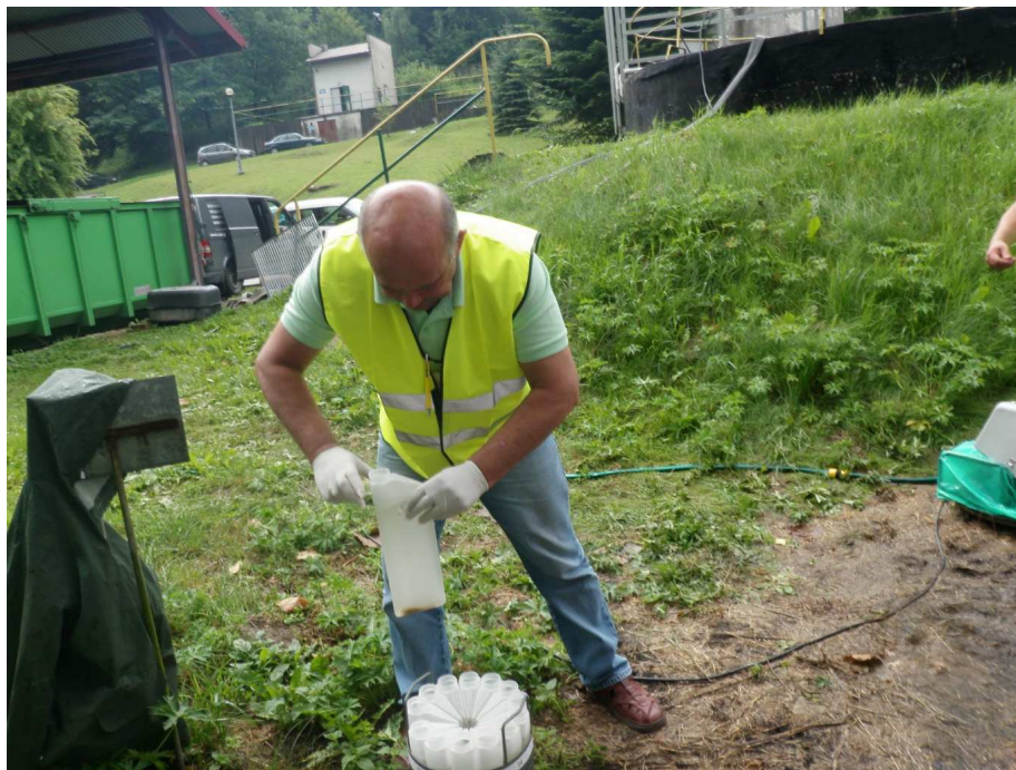
Ryc. 1. Pobór próbek ścieków odpływających z oczyszczalni w Polańczyku wykonany przez Laboratorium WIOŚ w Rzeszowie z użyciem sprzętu do poboru próbek zakupionego w ramach Programu Operacyjnego „Infrastruktura i Środowisko”. Polańczyk, 2015-07-15.
